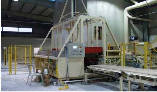
Şekil 7. Soğuk preste sıkıştırılmış ve kancalanmış bloklar halindeki levha taslakları
