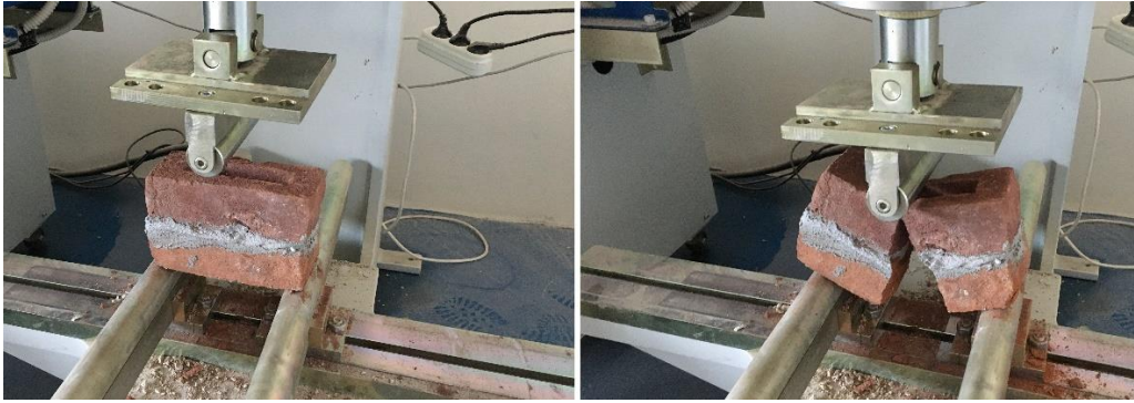
Şekil 10. Şahit numunenin 3-noktalı eğilme deneyinin gerçekleştirilmesi
