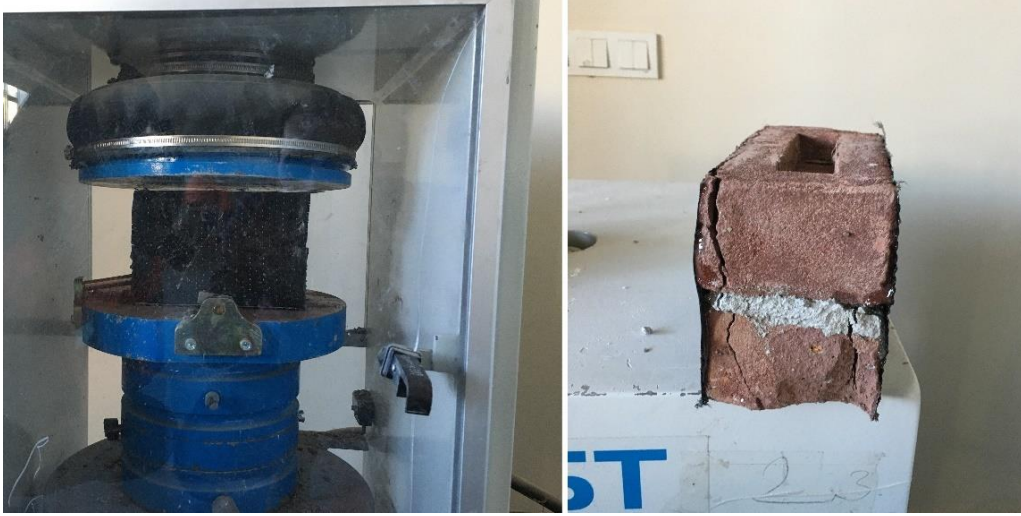
Şekil 11. CFRP kumaşla güçlendirilmiş numunelerin basınç deneyinin gerçekleştirilmesi
