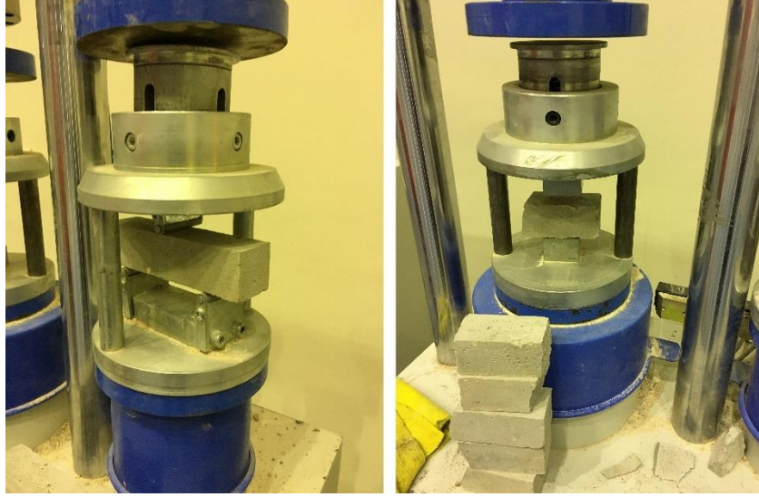
Şekil 8. Harç numunelerin basınç ve 3- nokta eğilme deneyinin gerçekleştirilmesi
