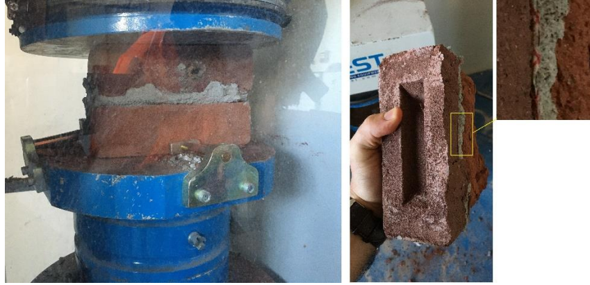
Şekil 13. Murfor® yatay derz donatısı ile güçlendirilmiş numunelerin basınç deneyinin gerçekleştirilmesi
