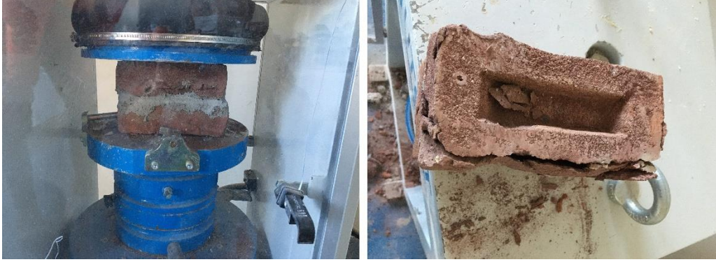
Şekil 9. Şahit numunenin basınç deneyinin gerçekleştirilmesi
