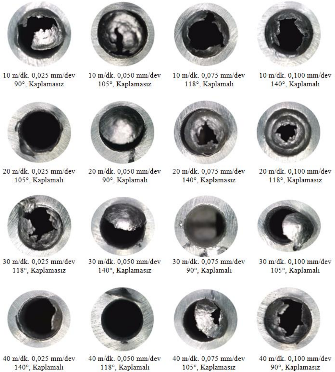
Şekil 10. Deneyler sonucu oluşan delik çıkışlarının görüntüleri (Exit images of the holes formed as a result of the experiments)
