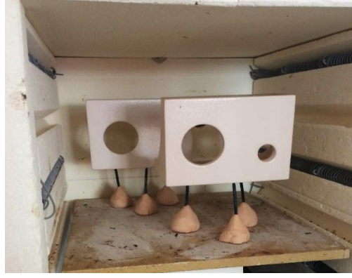
Resim 11. Önerilen Test Tüpü Bekletme Standının (Seratüp) 1200°C'de elektrikli fırından pişirim sonucu bir görüntü. (Sırlı pişirimde refrakter raf yüzeye yapışmaması için çivili ayaklar kullanılmıştır), (Kaynak: Caner Yedikardeş Fotoğraf Arşivi).
