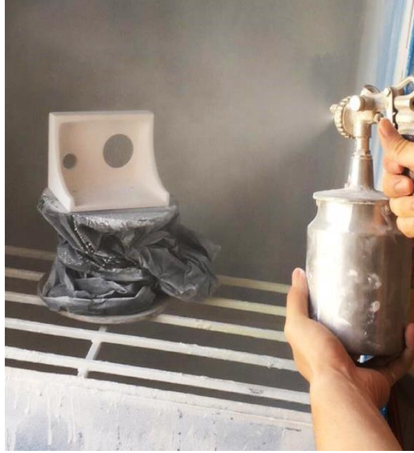
Resim 10. Önerilen Test Tüpü Bekletme Standı (Seratüp) kalıbından alınan ilk kil dökümün bisküvi pişirimi sonrasında sırlı (II.) pişirim için püskürtme yöntemiyle sırlama aşaması (Kaynak: Caner Yedikardeş Fotoğraf Arşivi).
