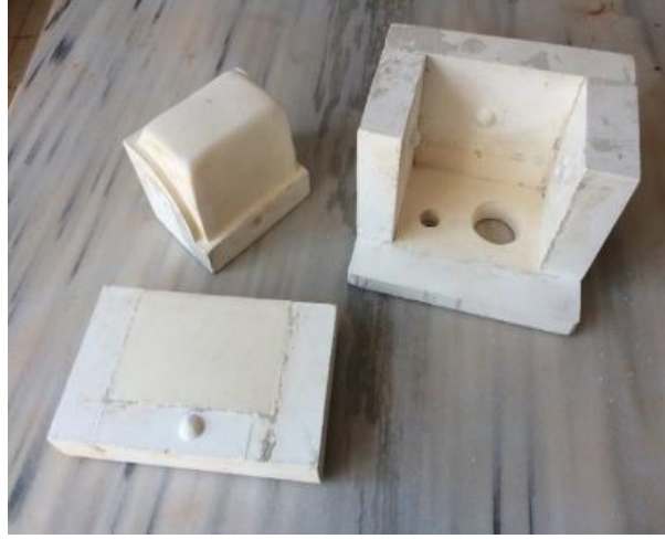
Resim 9. Önerilen Test Tüpü Bekletme Standı (Seratüp) Modelinin Parçalı Alçı Malzemedeki Kalıbı (Kaynak: Caner Yedikardeş Fotoğraf Arşivi).
