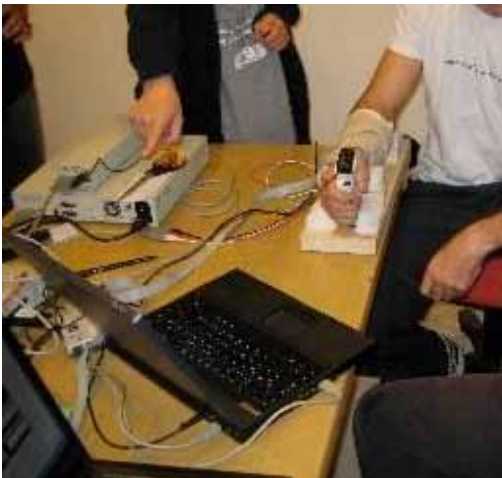
Şekil 2: El sıkma deneyinden bir fotoğraf ve ön kolda YEMG elektrotlarının ve ışık alıcıları-vericisi yerleştirme şeması. Ölçüm el sıkma protokolüyle %50 ve %75'lik maksimum el sıkma kuvvet seviyelerinde alındı. YEMG elektrotları ile ışık alıcı-vericileri yan yana flexor digitorum superficialis kasının üstüne yerleştirildi.
