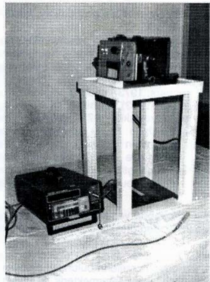
Şekil 2: Deneklere film çekmek için kullandığımız portatif röntgen aygıtı, sabitleştirme sehпасı, ışın miktarını ölçtüğümüz dozimetri ve sehпасın ayakları arasında ışın saçılmasını önlemek için kullanılan yarıklı kurşun levha görülmektedir.
