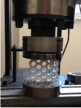
Şekil 4. Basma mukavemeti testi esnasında numunenin konumlandırılması
