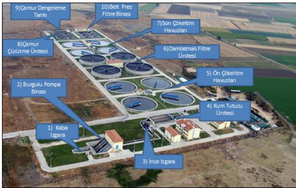
Şekil 3. Arıtma Tesisi Kademeleri
