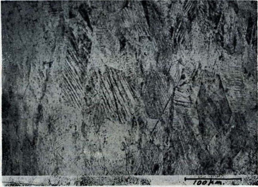
Şekil 2: Harrington Çubuğunun Boyuna Kesitinin Mikroyapısı.
