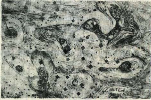
Şekil : 2 — Femur kemiğinde enine alınan bir kesitin mikro yapısı. Mikrografta sertlik izleri görülmektedir.
