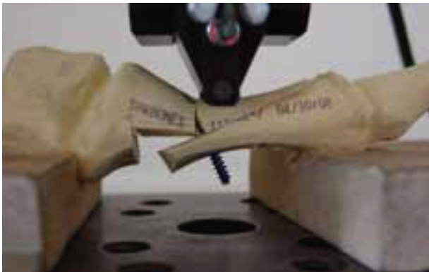
Şekil 2. Çekme-basma test cihazı düzeneği ve yeni Mau modifikasyonu yetmezlik görüntüsü.
