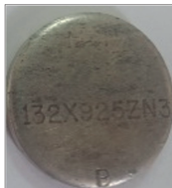
Figure 2: Certified silver reference material used for spectrometer reliability (132x925Zn3). / Spektrometrenin güvenilirliği için kullanılan sertifikalı gümüş referans (132x925Zn3).
