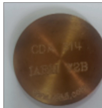
Figure 1: Certified bronze reference materials sample used for P-EDXRF spectrometer reliability (CDA 314UNS C31400). / Spektrometrenin güvenilirliği için kullanılan sertifikalı tunç referans (CDA 314UNS C31400).
