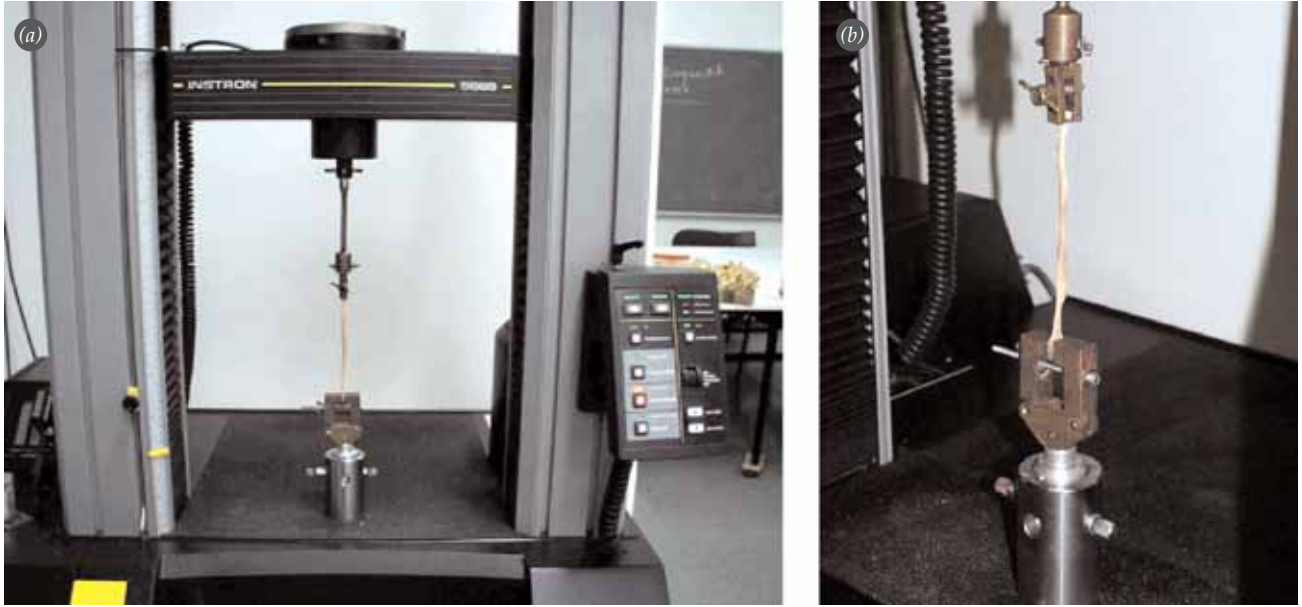
Şekil 4. (a) Instron® cihazı ve (b) tendon dayanma gücü ölçümü cihazı. [Bu şekil, derginin www.aott.org.tr adresindeki online versiyonunda renkli görülebilir]
