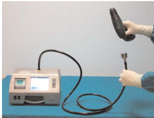
Şekil 3. Çalışır haldeki matkap motorun tahliye deliğinden partikül sayımı. [Bu şekil, derginin www.aott.org.tr adresindeki çevrimiçi versiyonunda renkli görülebilir]
