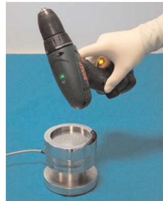
Şekil 4. Çalışır haldeki matkap motorun tahliye deliğinden mikrobiyolojik örnekleme. [Bu şekil, derginin www.aott.org.tr adresindeki çevrimiçi versiyonunda renkli görülebilir]
