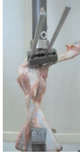
Şekil 3. Instron 8874 cihazı üzerinde kadvra koyun omuzu fotoğrafı. [Bu şekil, derginin www.aott.org.tr adresindeki çevrimiçi versiyonunda renkli görülebilir]
