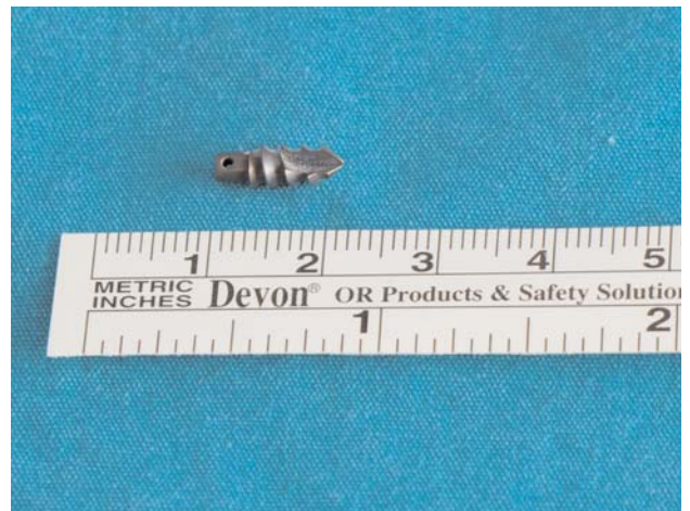
Şekil 1. Ti-6Al-4V ankorunun fotoğrafı. [Bu şekil, derginin www.aott.org.tr adresindeki çevrimiçi versiyonunda renkli görülebilir.]
