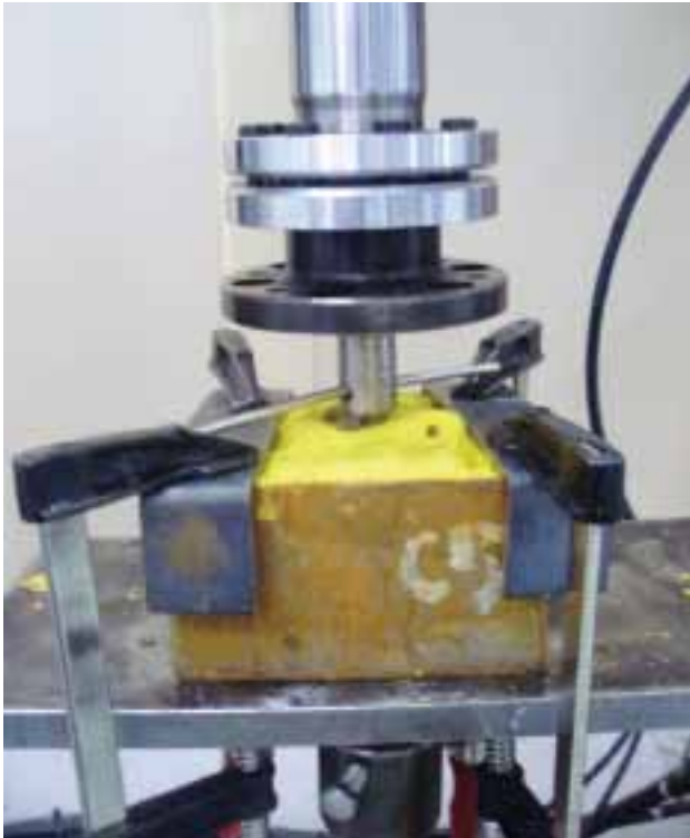
Şekil 2. Tüm omurlar ön yüzlerinden çimento içine gömüldü ve sıyırılma testleri bir materyal test aygıtı kullanılarak yapıldı. [Bu şekil, derginin www.aott.org.tr adresindeki çevrimiçi versiyonunda renkli görülebilir.]
