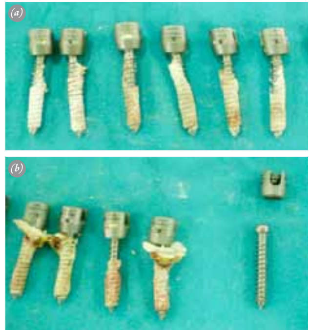
Şekil 3. (a) Sıyırılma testleri sonrası CAS ile kuvvetlendirilmiş vidaların görüntüsü. Vida yivlerinin tamamının kalsiyum sülfat çimento ile kaplandığı görülmektedir. (b) Sıyırılma testleri sonrası PMMA ile kuvvetlendirilmiş vidaların görüntüsü. Bir vidada test işlemi sırasında poliaksiyel baş kırılması gözlenmiştir. [Bu şekil, derginin www.aott.org.tr adresindeki çevrimiçi versiyonunda renkli görülebilir.]
