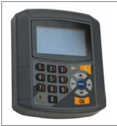
Şekil 2: Sınıf kapılarına yerleştirilmiş olan "mifare" kart okuyucu.
