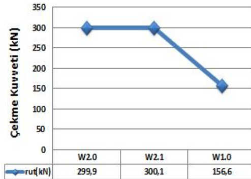
Şekil 11. Kolon ve kiriş sabit olup, değişken braketler ile cıvata çekme kuvveti ( r_{ut} ) ilişkisi
