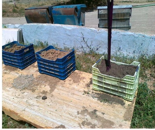
Şekil 4. TDR 300 cihazı kalibrasyonu.
