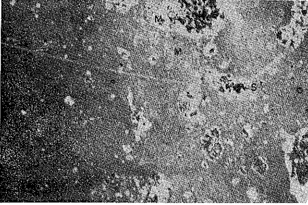
Foto 8. Çeşitli derecelerde izlenen ornatma (metasomatoz) bazı parçaların hacminin büyük bir bölümünde etkili olmuştur. M; magnezit, S; serpentinite ( \times nikol, 50 \times ).
