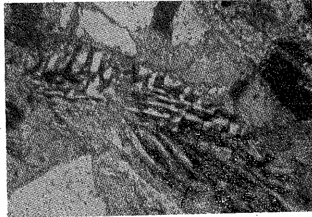
Foto 3 : Triyas kumtaşı, 100x Granit parçası: mikro yazı graniti olup, yazı graniti tekstürü göstermekte, (sağ alt köşeden, sol üst köşeye doğru devam eden alacalı görünümlü). Kuvars: gri-beyaz, benekli görünümlü, sol alt köşede ve üstte. Çimento: taneleri saran dalgali, gri görünümlü, kalsit mikro tanelerinden oluşmaktadır.
