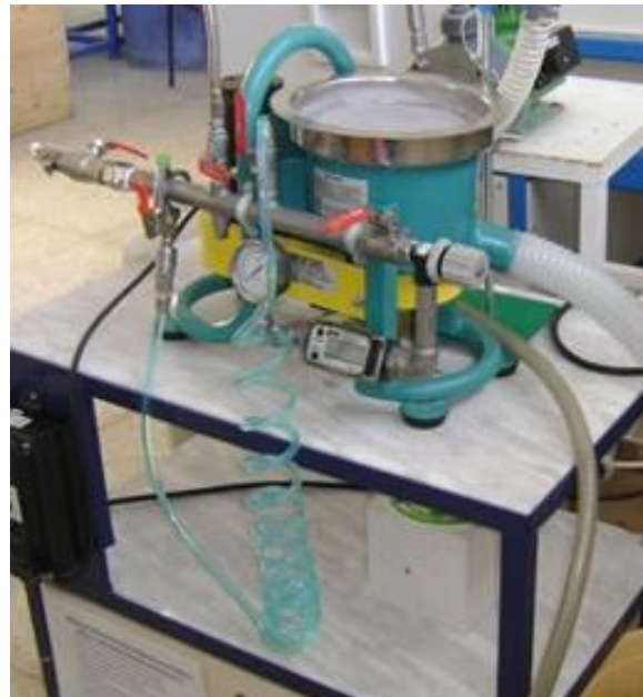
Şekil 2. Deneysel çalışmalarda kullanılan Knelson konsantratör.
