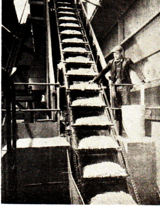
Resim 1 : Talaşları ügütücülere sevkeden elevatör.
