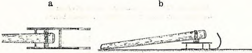
Resim 8. Tomruk ya da gövdenin kalın başının bir kızak üzerine bindirilerek sürütülmesi: a) üstten, b) yandan görünüş.
