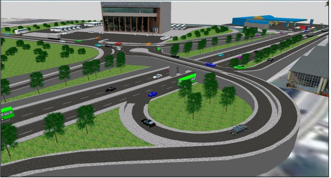
Şekil 8. Trompet kavşak öneri simülasyonu
