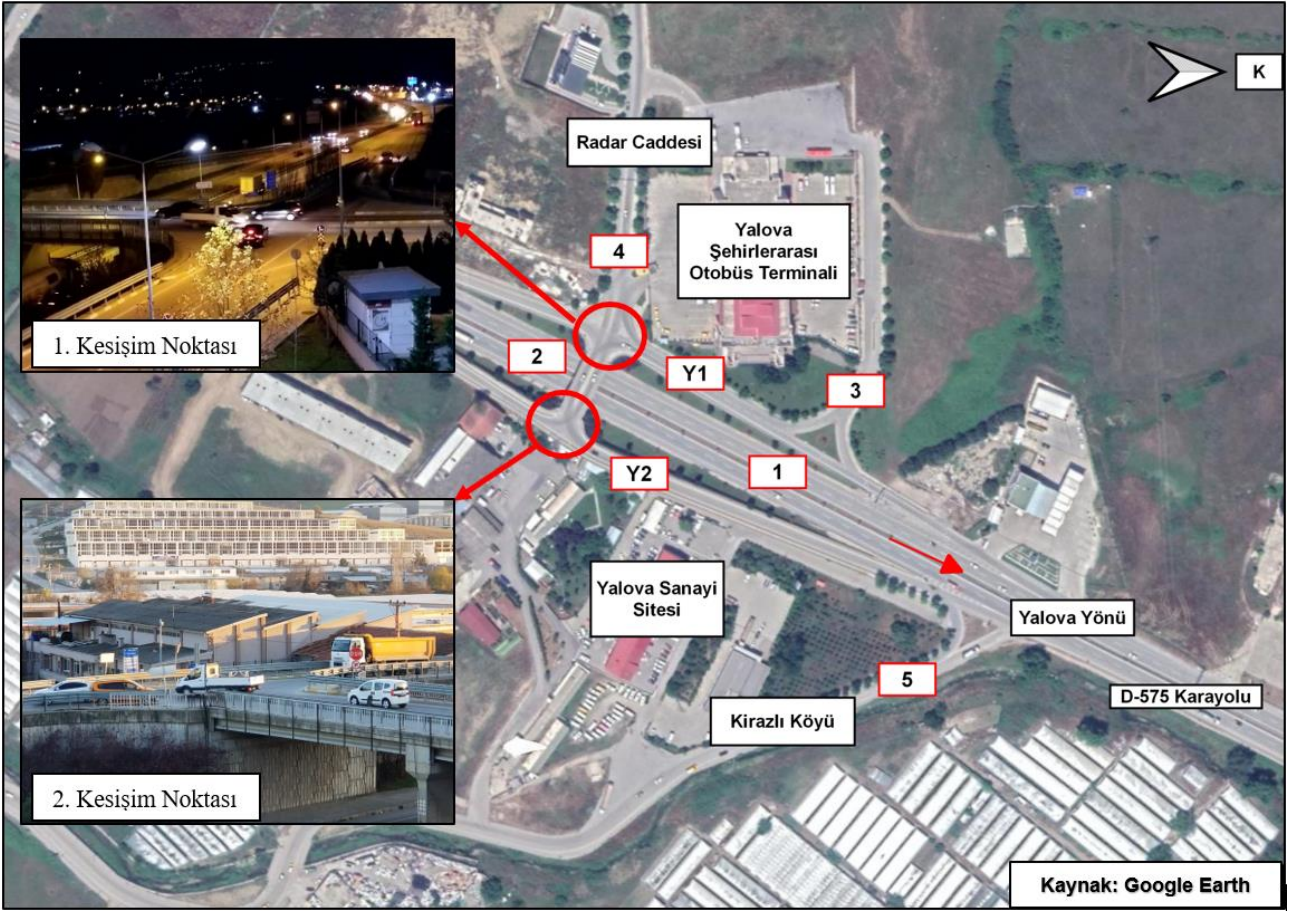
Şekil 5. Yalova Otogar katlı kavşağındaki akım kesişmeleri ve güvenlik sorunları (Int Kyn. 1)
