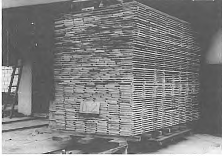
Resim 1 : Kurallara uygun şekilde yapılmış bir kereste istifi.
