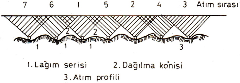
Şekil 4: Saniyeli fitillerle ateşleme şekli (ERDAŞ 1988)
