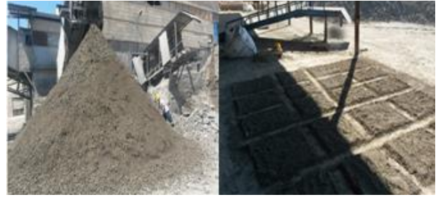
Şekil 1. Hisarcık konsantratör tesisi numune alma ve hazırlama işlemleri.
