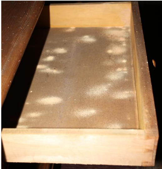
Şekil 8. Çekmece içinde görülen Anobium punctatum öğüntü tozları (MS Arşivi) Figure 8. Wooden fine dust (frass) of Anobium punctatum appeared in the drawer (NP Archive)
