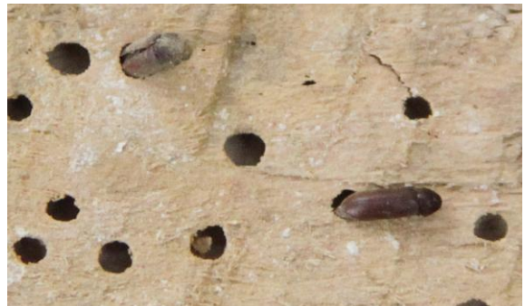
Şekil 11. Anobium punctatum (De Geer) erginleri ve uçma delikleri (MS Arşivi) Figure 11. Adults of Anobium punctatum (De Geer) and exit holes (NP Archive)
