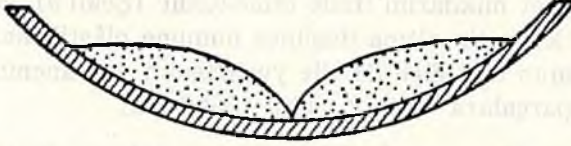
Şekil 7. Likit limit denemesinde açılan izin denemeden sonraki durumu
