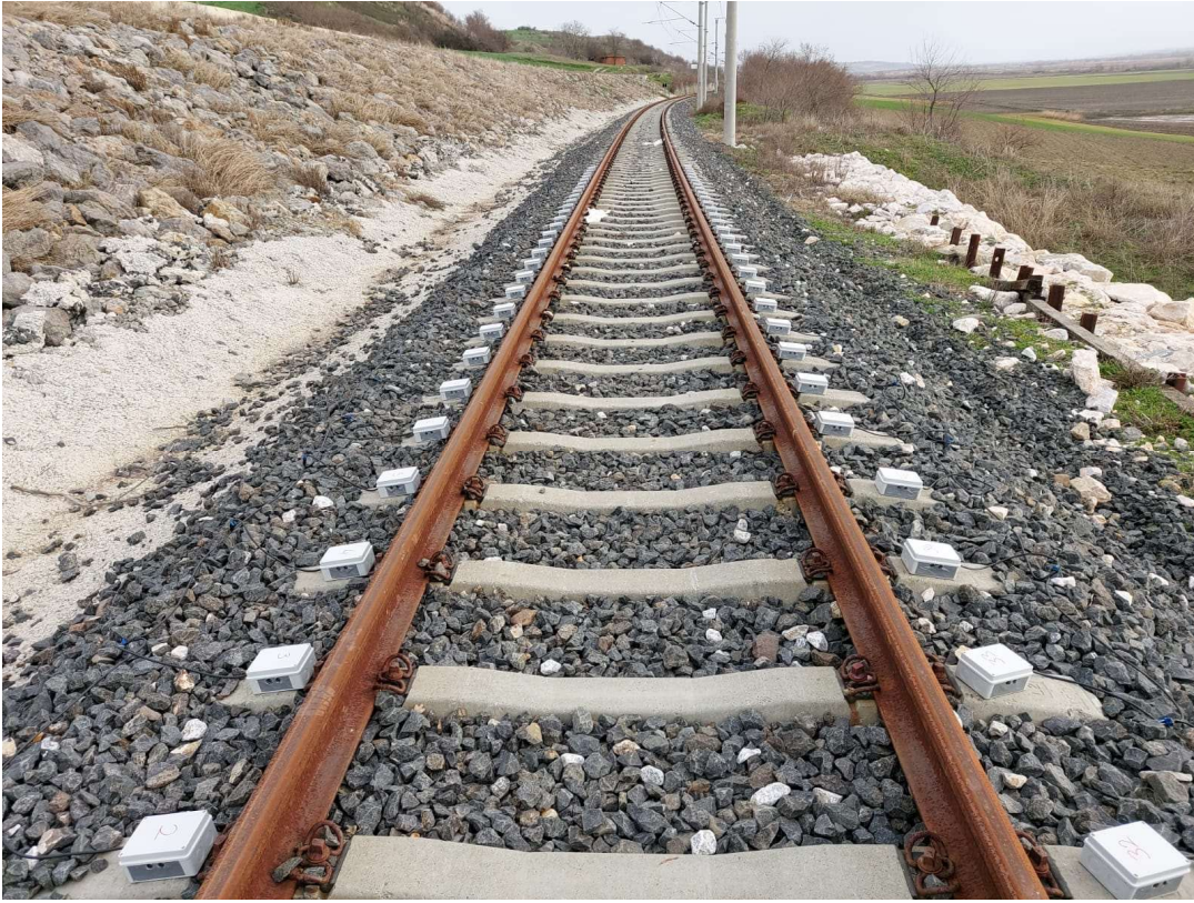
Şekil 7. 11/02/2021 tarihli teste mesafe ölçerlerin çalışma bölgesindeki traverslere yerleştirilmesi.
