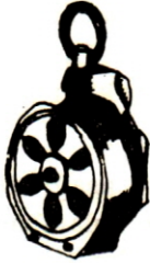
Resim 4. Oynak bir halat makarası (alüminyum dökme)
