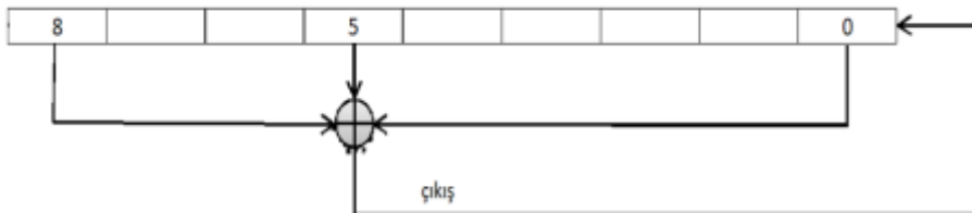
Şekil 2. X^9 + X^6 + 1 Denklemi Gerçekleyen LFSR Şeması
