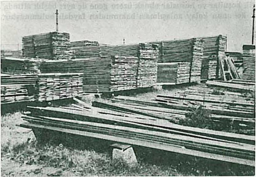
Resim 1 — Doğal kurutmada, (üstte) istif depo yeri, zemini ve istif temelleri ile ilgili önemli koşulları yerine getirilmiş bir istif yeri ve burada tekniğine uygun şekilde yapılmış bir kereste istifi, (altta) bu koşulların yerine getirilmediği diğer bir istif alanı ve bu alan üzerinde hatalı ve düzensiz yapılmış kereste istifleri.
