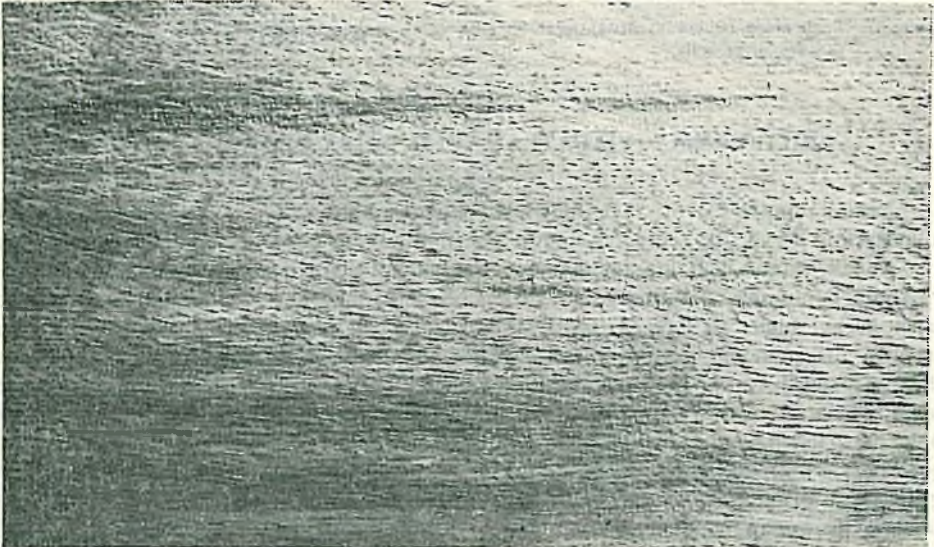
Resim 2 : Çoruh meşesi ( Quercus dschorochensis K. Koch) tomruklarında enine kesitlerden içeriyeye doğru dil şeklinde uzanan kahverenkli şeritlilik.
