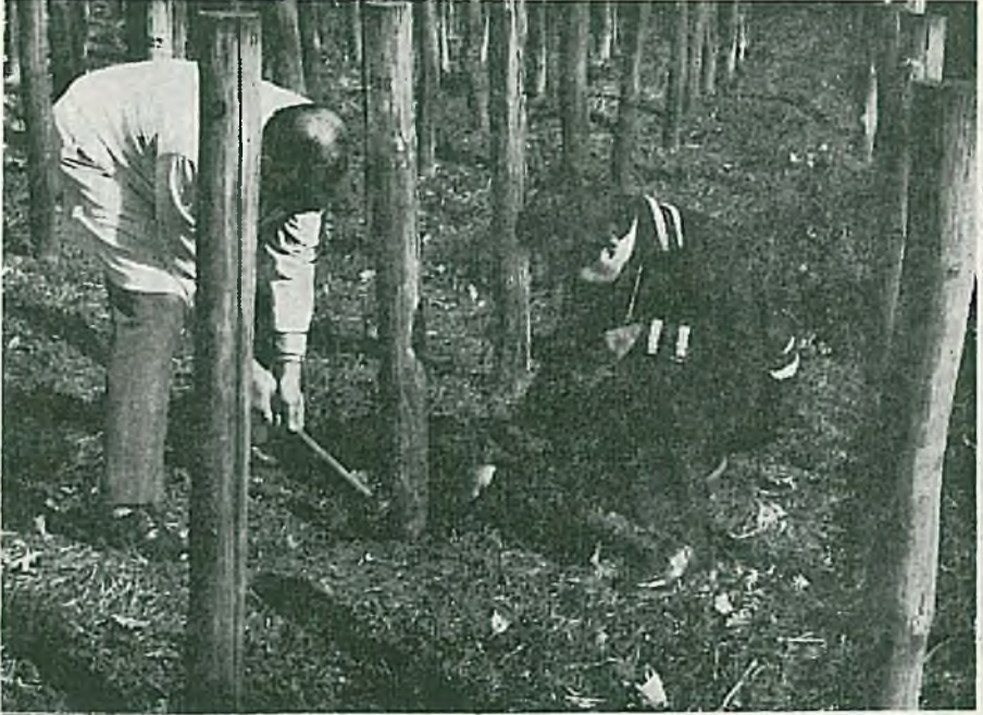
Resim 5 : Çit direklerin yıllık kontrollerinde sağlamlık durumlarının muayene şekli.
