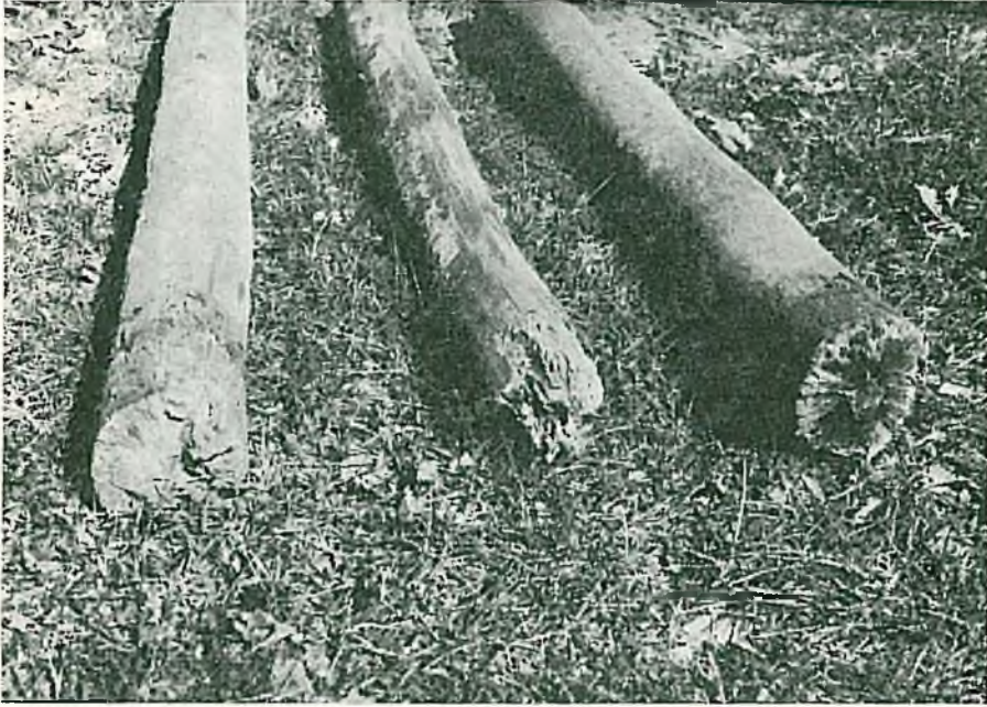
Resim 7 : Toprak yüzeyine yakın kısımlardan çürümüş bulunan bazı deneme çit direkleri.
