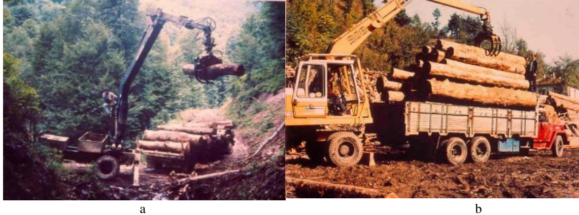
Şekil 5. Granab (a) ve Liebherr (b) yükleme vinci ile kamyonların yükleme Figure 5. loading trucks with loading crane of Granab (a) and Liebherr (b)
