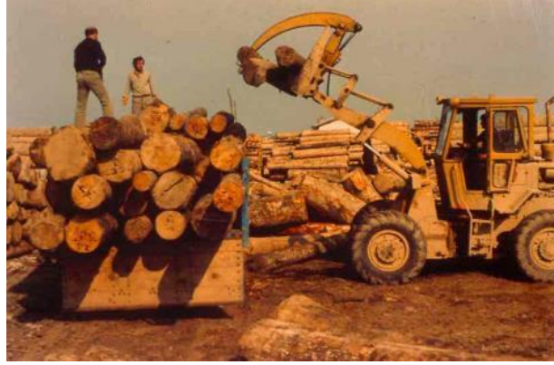
Şekil 4. Hidrolik kısıkaçlı yükleyici ile yükleme Figure 4. Loading with hydraulic grapple loaders
