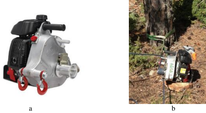
Şekil 6. Taşınabilir el vinci ve ağaca sabitlenmiş halde kurulumu Figure 6. Portable manual winch and fixed installation on tree
