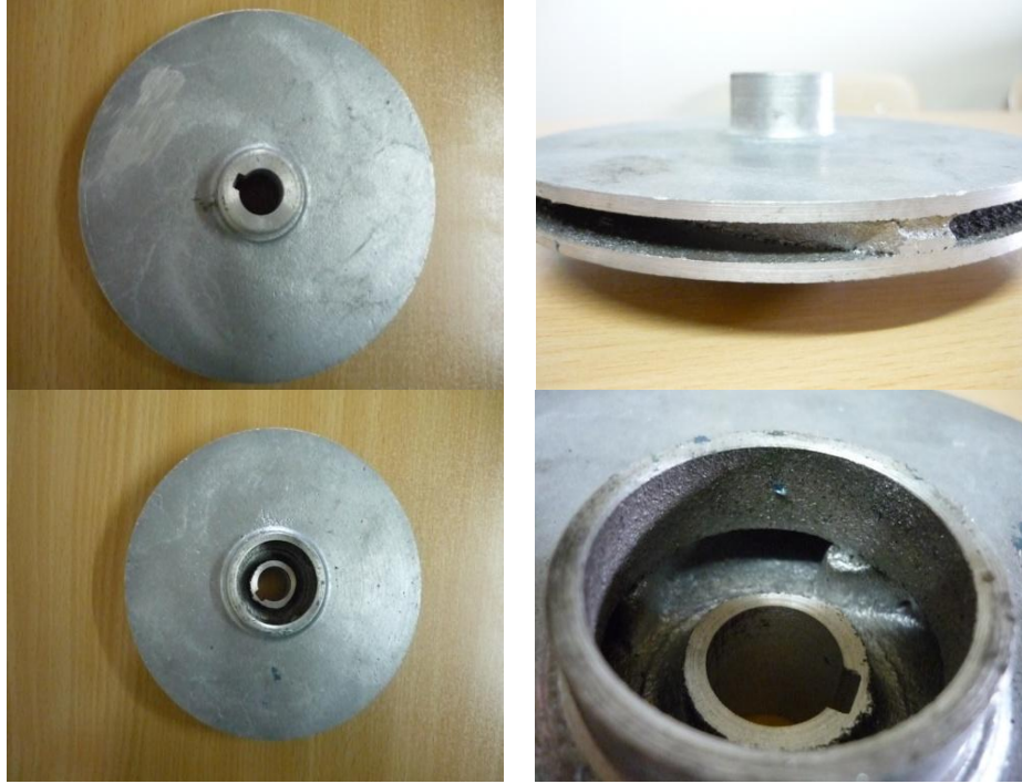
Şekil 5. 180 saatlik sürede denemesi yapılmış alüminyum çarkın denemeden önceki makro yapı görüntüleri
