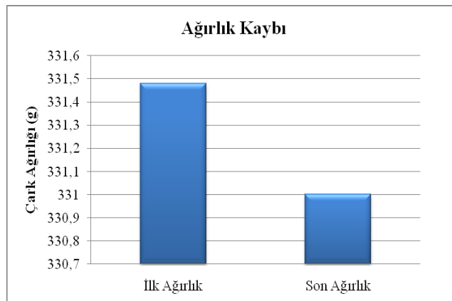
Şekil 8. Alüminyum çarkta meydana gelen ağırlık kaybı Figure 8. Weight loss occurring in the aluminum wheel
