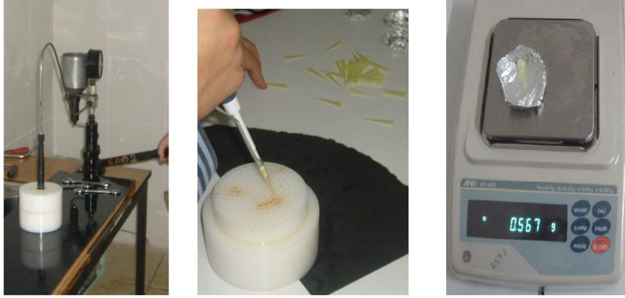
Şekil 4. Yakıt hücrelerine yakıtın püskürtülmesi ve hücrelerde toplanan yakıt miktarlarının saptanması.
