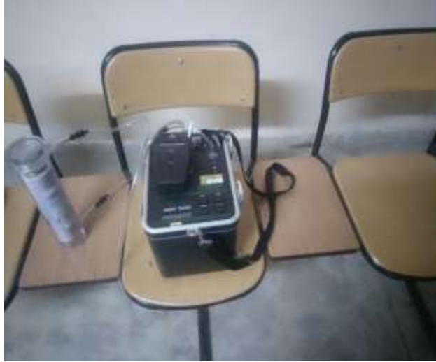
Őekil 6. DURRIDGE Rad7 elektronik radon dedektr ile bina iinde yapılan lm
