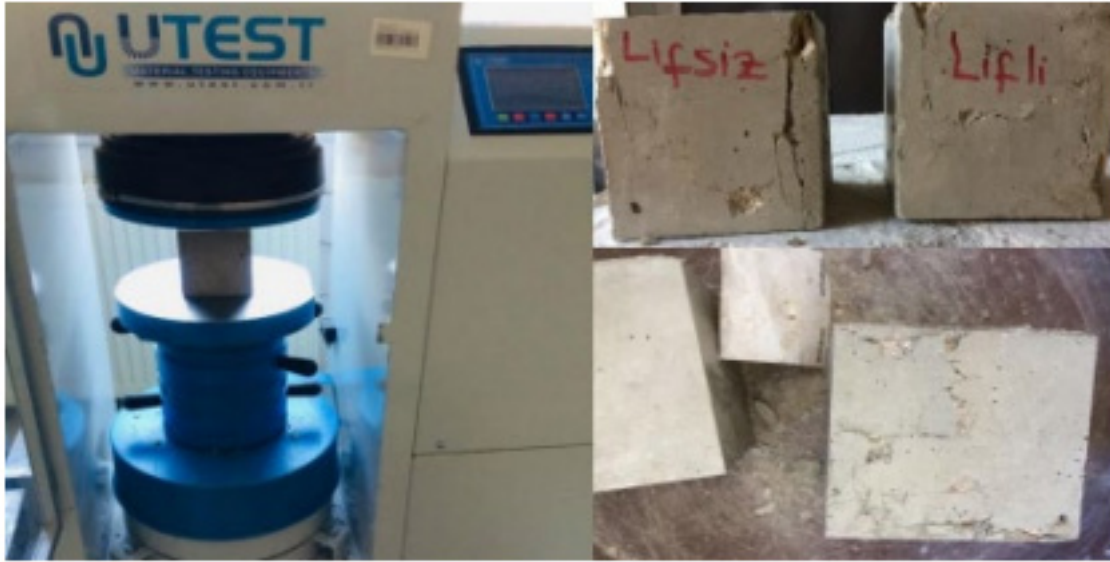
Şekil 6. Beton Test Presi Ve Test Edilmiş Numuneler. (Mayar, 2020)
