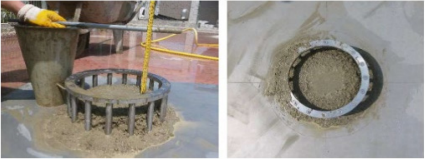
Şekil 7. J halkası Donatıları Arasında Sıkışan Lifler (Ouedraogo, 2018).
