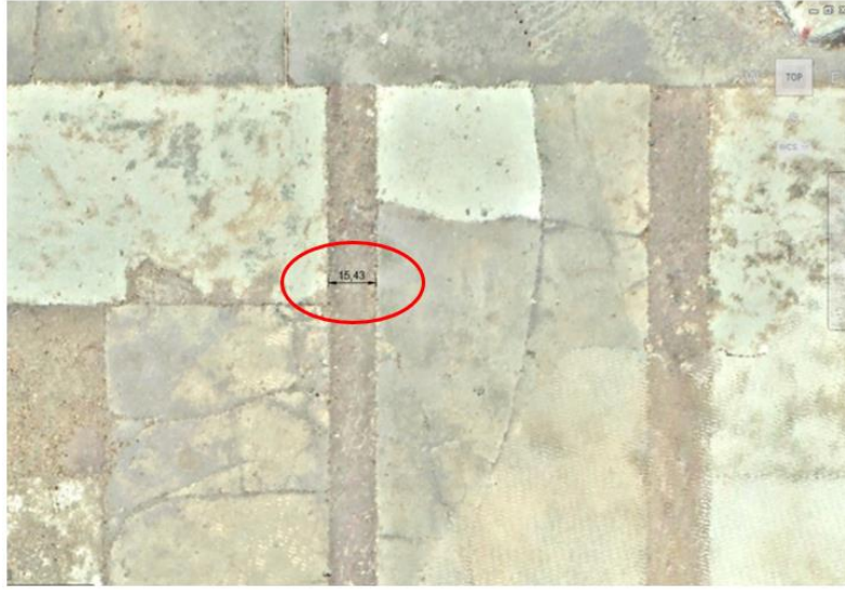
Şekil 5. Lazer tarayıcıdan elde edilen ölçüyü gösteren ekran görüntüsü örneği
