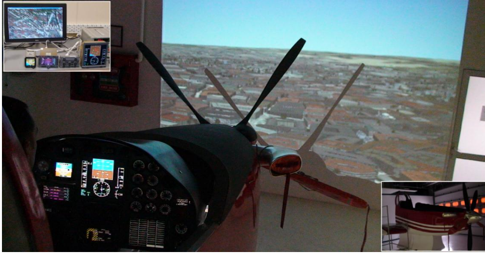
Şekil 10. RAHAT Donanımın Masa Üzerinde (sol üst köşe) ve Gövveye Entegre Benzetimde Çalışırken Görüntüsü (büyük resim).
