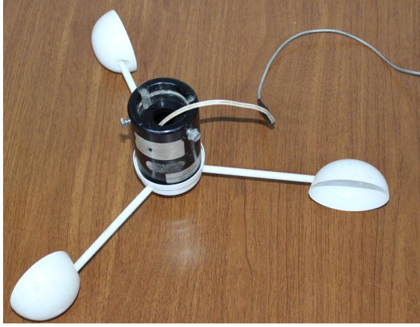
Şekil 6 Hız Ölçümü İçin Optik Sensör Montajı
