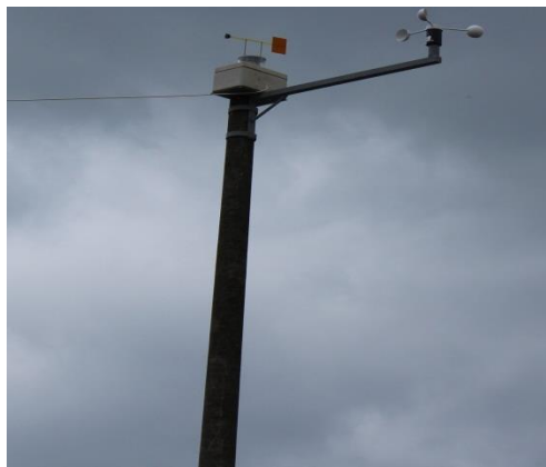
Şekil 13 Ölçüm Sisteminin Ölçüm Direğine Montajı
