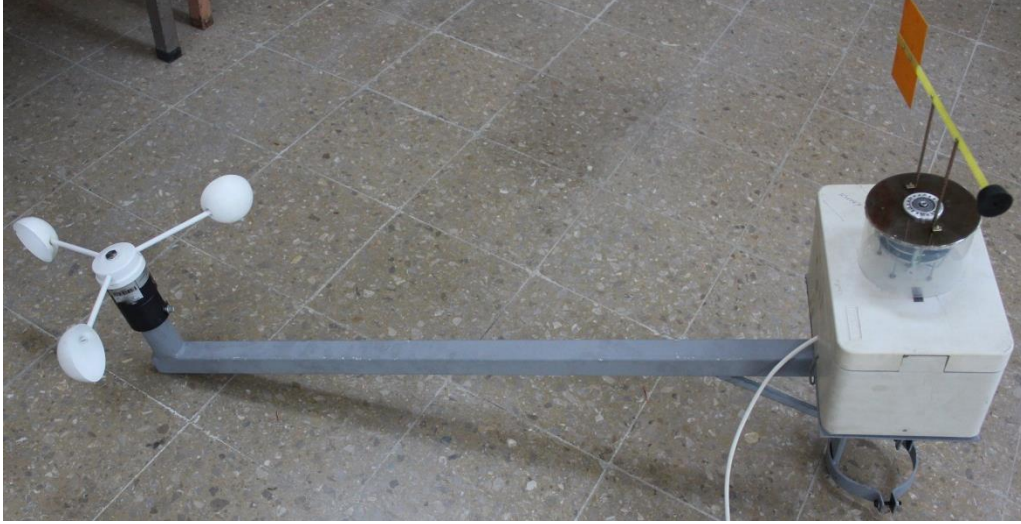
Şekil 12 Ölçüm Sisteminin Yan Kol Montajı
