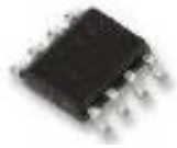
Şekil 2.5. TC77 sıcaklık duyargası
