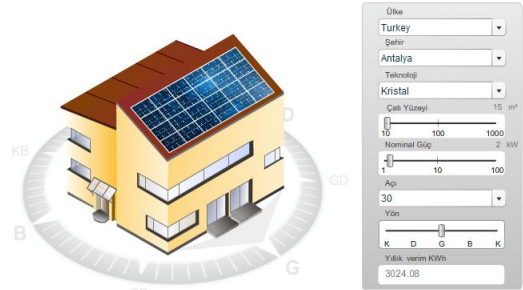
Şekil 1. 15 m 2 kristal teknoloji güneş pilinin 1 yıllık verimi (Ibcsolar, 2013).
