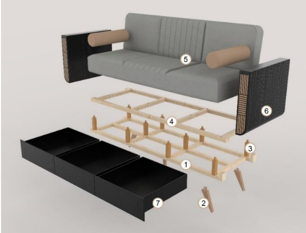
Şekil 10. Mobilyanın kurulumu (The installation of the furniture)
