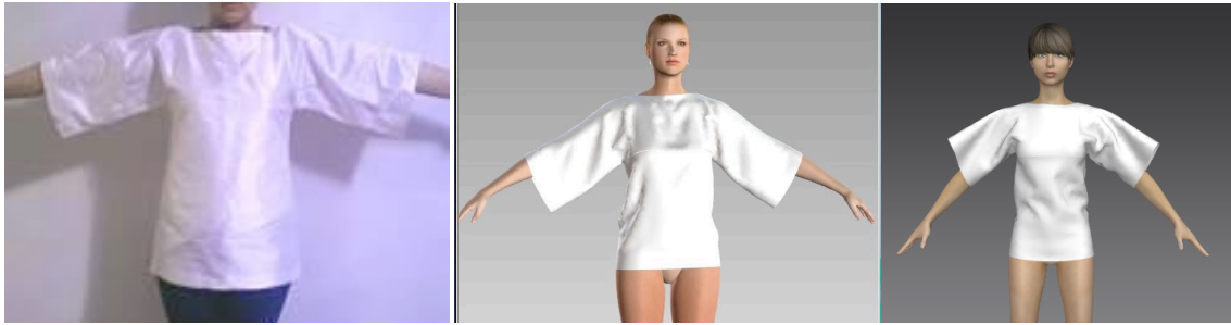
Resim 15: Model 3 gerçək ürün görseli (sol), 3D simülasyonları: Optitex (orta), Marvelous Design (sağ)
