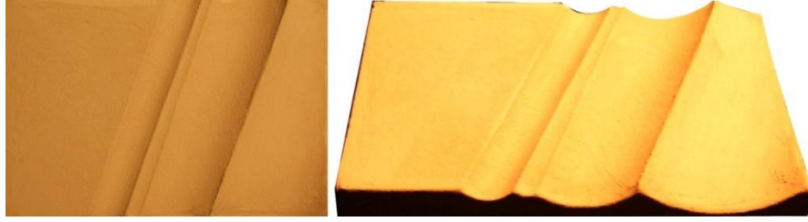
Şekil 6. Alçı Çekirdeğin Kalıbı Alınarak Seramik Döküm Çamuru İle Üretimi. 6
