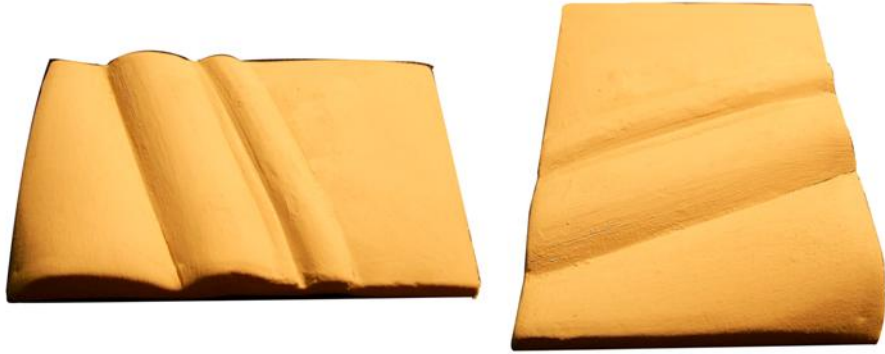
Şekil 7. Pozitif Kalıbın Seramik Döküm Çamuru İle Üretimi. 7
